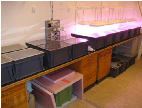
Figur 2. Försöksuppställning i labbet. Lådor med lysrör ovanför är lådor med algexponering.
