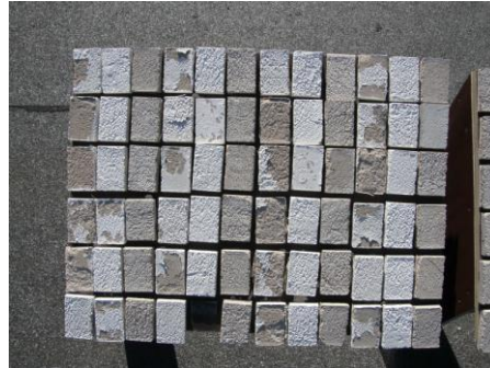
Figur 6. Krakerlering av (Murvärns)färgen på putsprovkropparna utomhus.
